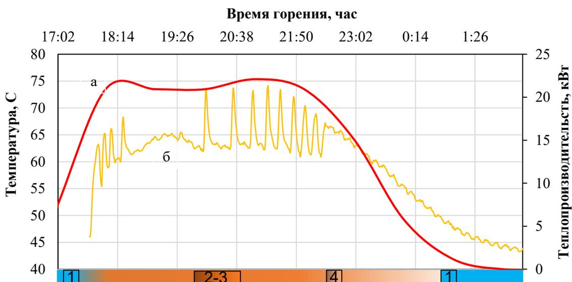
Рис. 7. Процесс горения котла на 1 закладке дровяного топлива:
